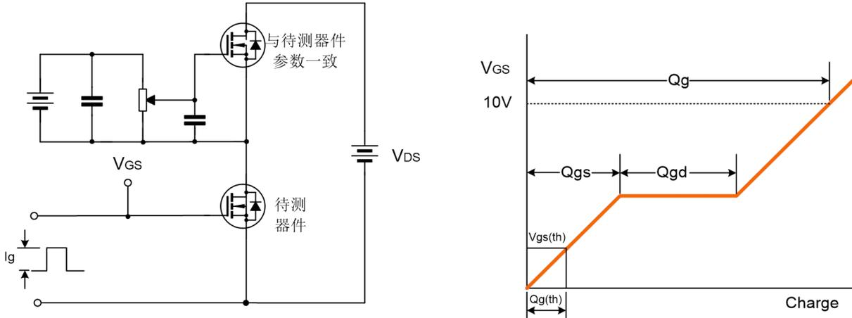
开关时间测试电路及波形图
